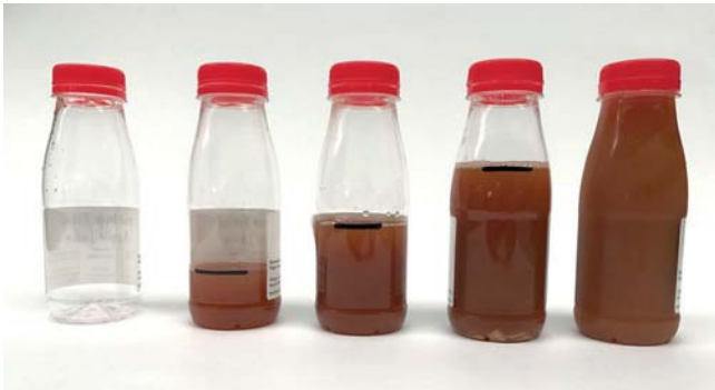
Abb. 3: Die Menge an Luft in der Verpackung hat beim HPP-Prozess keinen Einfluss auf das Produkt.
