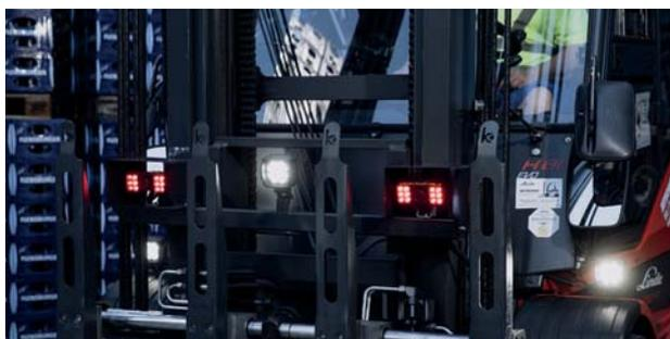
Handscanner waren gestern: Wenn die Staplerfahrer bei der Flensburger Brauerei Lkw mit gefüllten Fässern oder Bierkästen beladen, erfasst eine Cognex-Kamera am Hubgerüst das Etikett der Palette und scannt den Barcode ein. Das spart Zeit, erhöht die Sicherheit im kombinierten Stapler- und Lkw-Verkehr und bewährt sich in der Praxis bestens ...
