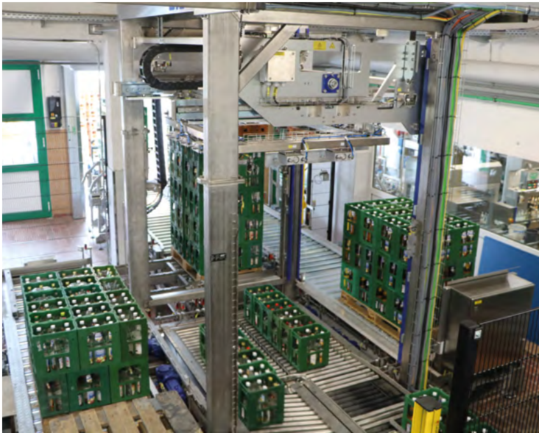
Der Unipal 104 kombiniert (v. l. n. r.) das Entladen, die Lagenbildung und -vereinzeln sowie das Beladen auf engstem Raum. © BMS Maschinenfabrik GmbH
