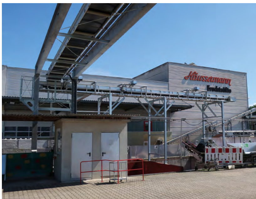
Die neue Förderanlage von Apullma automatisiert die Annahme, Entlaubung und Sortierung von Streuobst. © alle Apullma
