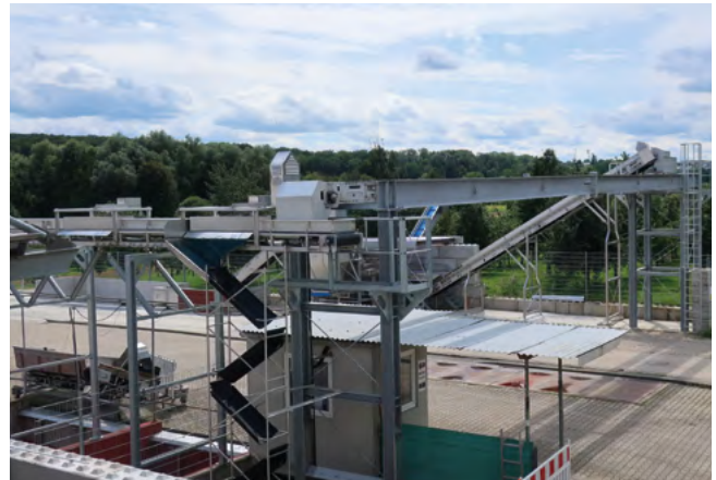
Die Ausscheider mit Fallrutschen zur Befüllung der Silos können bedarfsgerecht angesteuert werden, um beispielsweise Bio- und QZBW-Ware zu trennen (Bild entstand nach Montage der ersten Fallrutsche).
