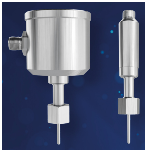
Die Temperatursensoren sind mit Mini- oder Standardkopf erhältlich, haben eine 3 mm Fühlerspitze für schnelle Ansprechzeiten und werden mit einer Überwurfmutter in der Tauchhülse eingeschraubt. alle © Anderson-Negele
